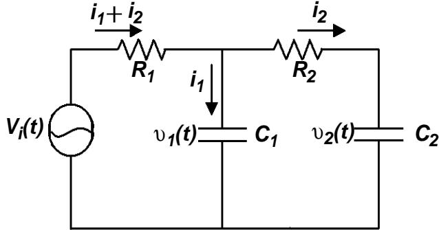
Θεωρώντας ότι οι τάσεις  $v_1(t)$ ,  $v_2(t)$  στα άκρα των δύο πυκνωτών αποτελούν την κατάσταση του κυκλώματος,
