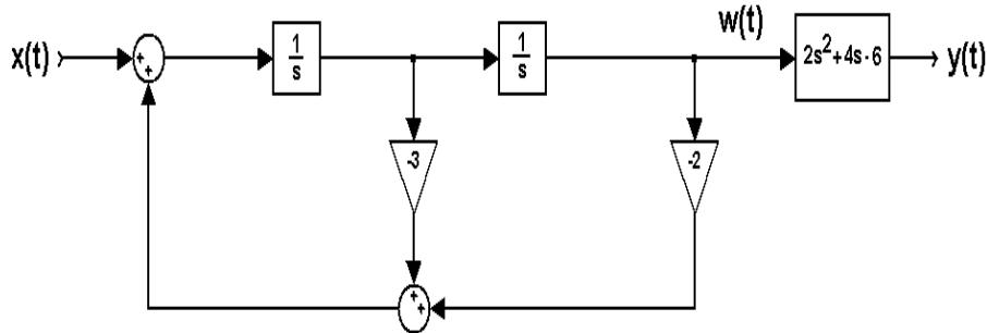
Ας υποθέσουμε ότι έχουμε μόνο τον όρο  $2s^2$  οπότε, αντί να στείλουμε το  $w(t)$ , το οποίο έχει περάσει από δύο ολοκληρωτές ( $\frac{1}{s^2}$ ), στο  $2s^2$ , μπορούμε απλώς να πολλαπλασιάσουμε με 2 το σήμα, πριν καν εισέρθει στον πρώτο ολοκληρωτή. Ακολουθώντας αυτή τη λογική, για να αποφύγουμε τα περιττά στη σειρά ζεύγη ολοκληρωτών-διαφοριστών, παίρνουμε το αποτέλεσμα της απευθείας υλοποίησης.
