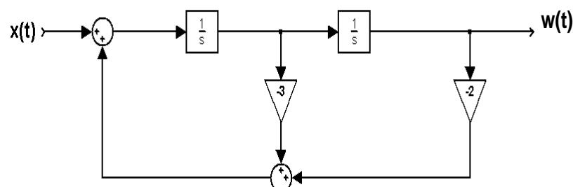
Προφανώς, για να πάρουμε την  $y(t)$  πρέπει η  $w(t)$  να περάσει από ένα σύστημα με συνάρτηση  $2s^2 + 4s - 6$  όπως φαίνεται στο επόμενο σχήμα
