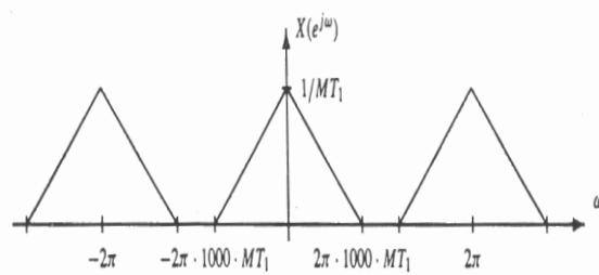
Με τη διέλευση μέσα από το μετατροπέα D/C, παράγεται ένα σήμα  $y_\alpha(t)$ , το οποίο έχει το μετασχηματισμό Fourier που φαίνεται στο ακόλουθο σχήμα.
