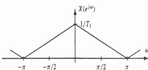
ενώ η έξοδος του χαμηλοπερατού φίλτρου φαίνεται στο ακόλουθο σχήμα.
