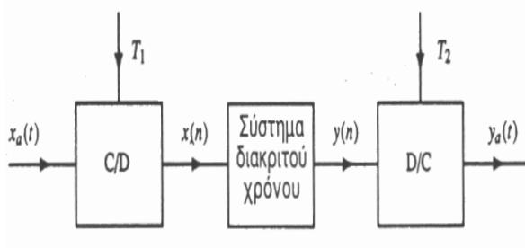
Υποθέτουμε ότι το σήμα  $x_\alpha(t)$  έχει περιορισμένο εύρος ζώνης με  $X_\alpha(f) = 0$  για  $|f| > 5$  KHz, όπως φαίνεται στο ακόλουθο σχήμα,
